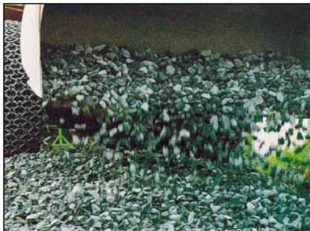
Abb. 1: Eisenbahnschotter als nichtbindiges Granulat
